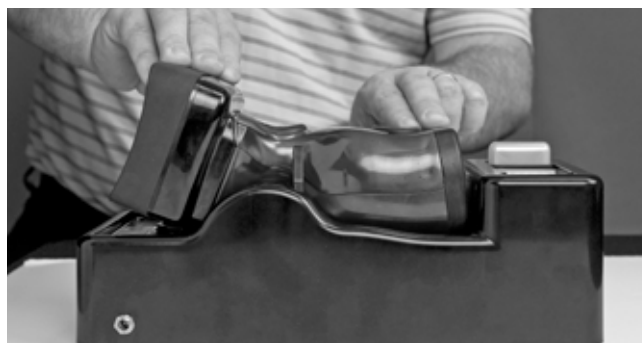
Falsch eingesetzte Wärmebildkamera im Powerhouse.
